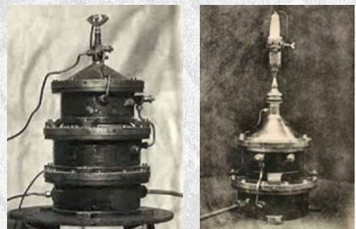
図5. アセチレンガス灯器(左)とアセチレンガス白熱灯器(右)
